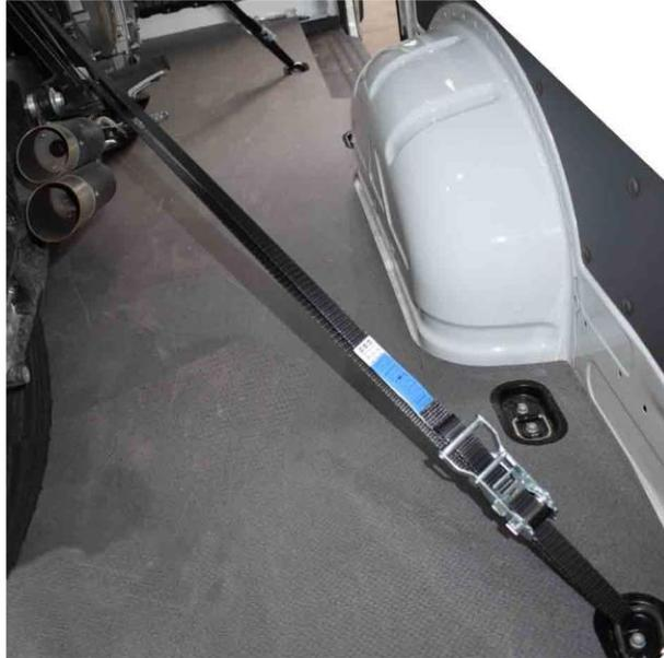
4. Losende straffziehen und mit der Ratsche den Spanngurt spannen.
