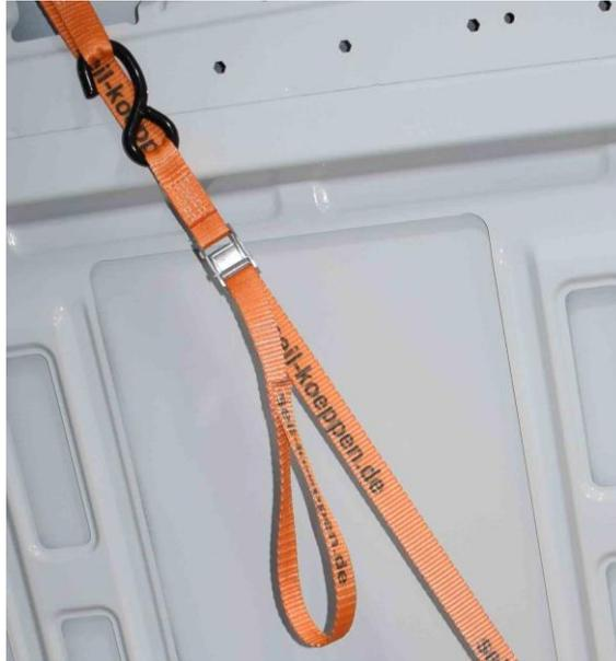
4. Den Spanngurt mit Hilfe der Schlaufe am Klemmschloß nach unten hin spannen. Gurte abwechselnd so spannen das das Vorderrad bzw. Hinterrad etwas einfedert.
